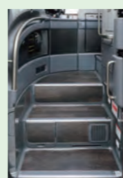
テッキ(手すり・キャビネット)
